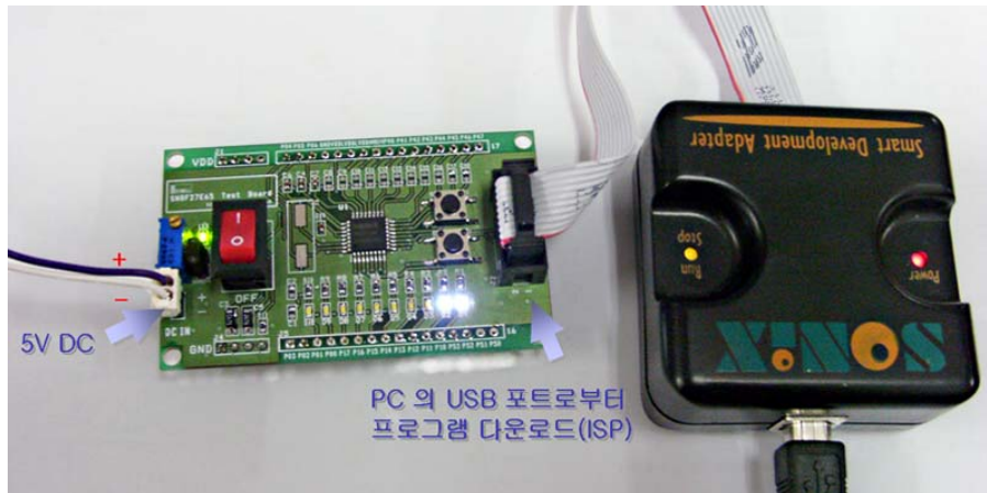
Fig 3.1. PC에서 ISP 인터페이스를 통하여 MCU로 직접 다운로드/ 디버깅
